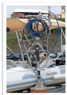
Poste com transdutor, cabos e GPS
